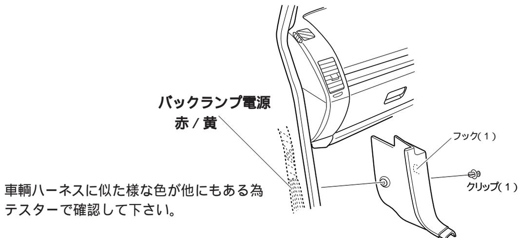
赤 / 黄の線にバックセンサー入力コードを接続します。
